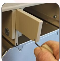
3. Pomocí pomůcky pro vytažení vytáhněte rozpěrné profily. Pomůcku zasuňte do mezery mezi profily a otočte o 90°.
