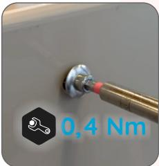
Dvířka jsou uzavřena pomocí šroubů M6, které jsou utaženy na hodnotu 0,4 Nm. Jedná se o hodnotu, kterou dosáhnete utažením pomocí např. šroubováku pouhou rukou.
